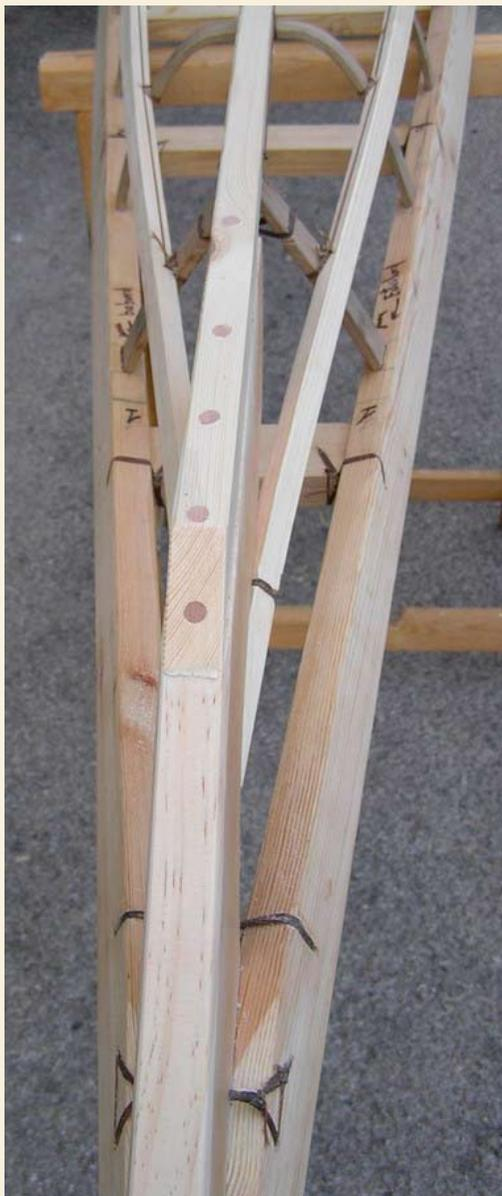
**E**l listón de quilla se enclavija a las piezas de proa y popa con clavijas de diámetro suficiente (8mm) Los agujeros se hacen inclinados, con inclinaciones opuestas, de manera que no se separen las piezas a unir. La foto muestra el proceso acabado, pero en realidad se enclavija antes de las ligadas y antes de colocar los stringers.
