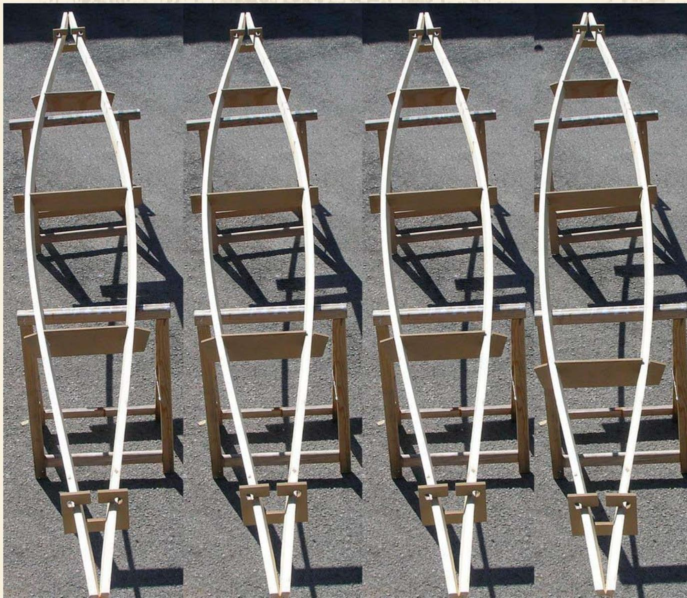
**E**n la imagen se puede apreciar cómo se altera el perfil de la cubierta con leves desplazamientos de las formas.
