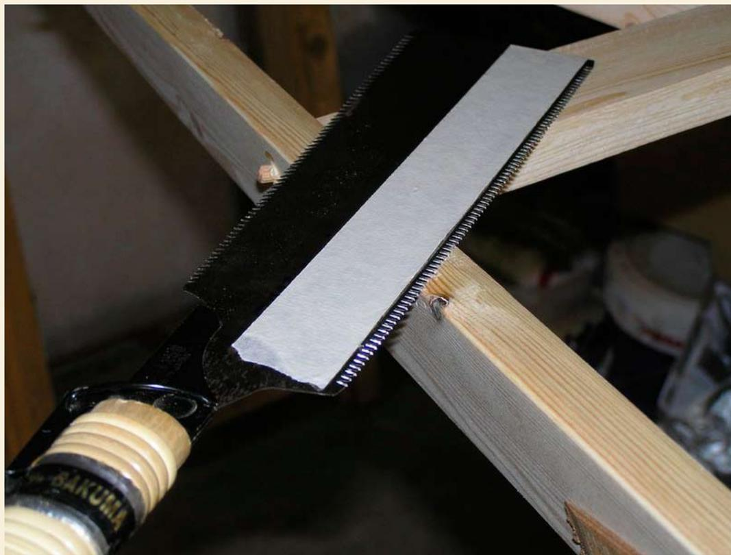
**L**as clavijas ya cortadas que se venden en bolsas son demasiado cortas para nuestros fines. Se compran en tiras de un metro y se cortan después a la medida correcta. Se pueden cortar algo más cortas que el agujero, para evitar que si se hinchan puedan notarse bajo la tela. Tampoco demasiado, para no crear un punto donde se acumule el agua y llegue a pudrir el tejido prematuramente.
