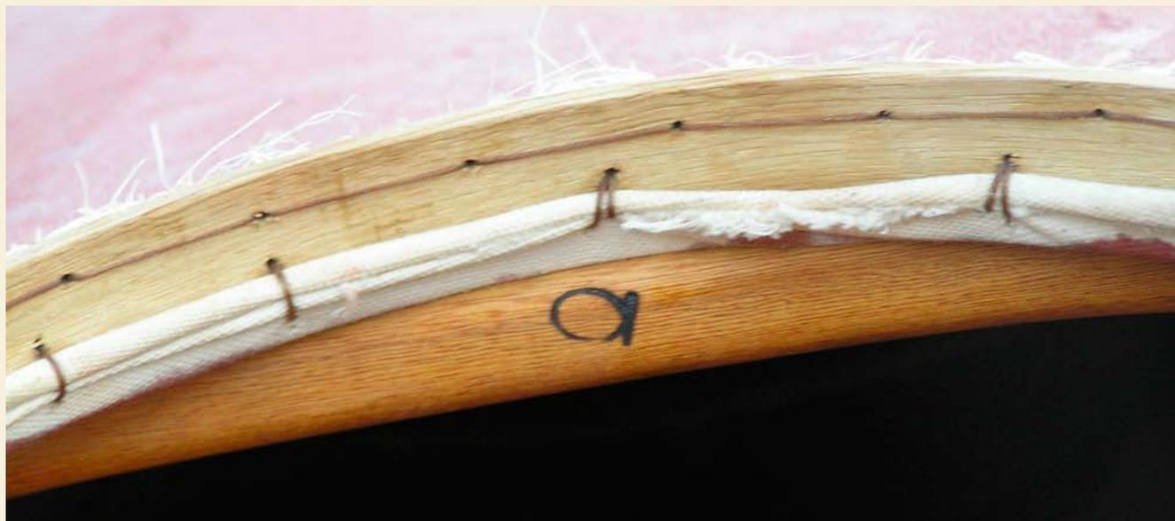
Las dimensiones máximas de la brazola de la bañera vienen determinadas por la distancia entre el masik y el respaldo en un eje y por la distancia entre bordas en el otro. En la práctica, la anchura máxima viene a ser la de las caderas más cuatro dedos, y la longitud es tal que el borde delantero descansa sobre el masik y el trasero queda o justo encima del respaldo o justo antes.
