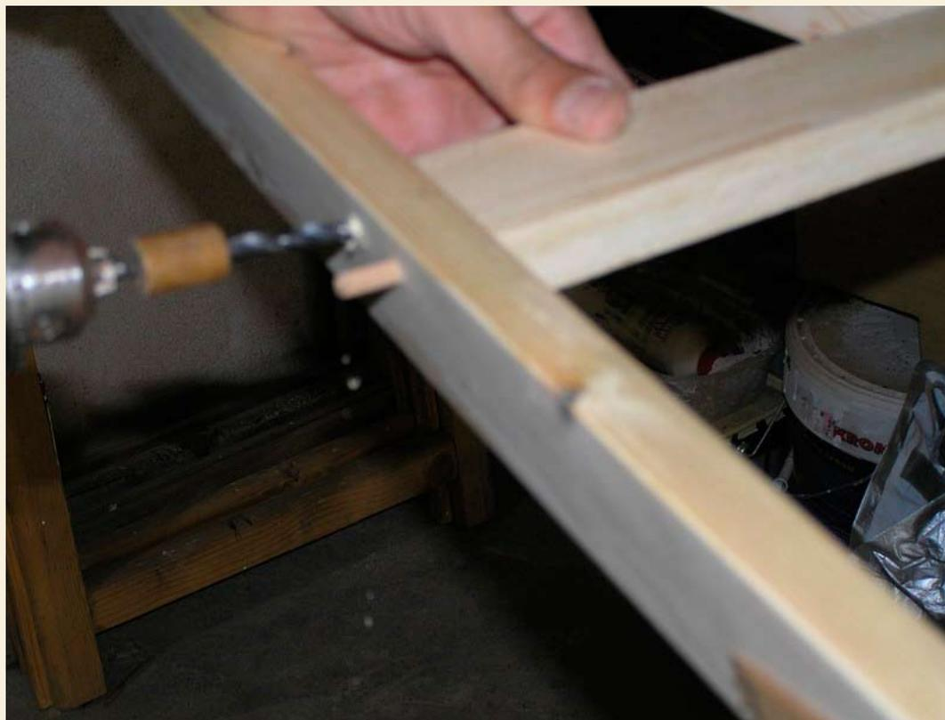
**D**os clavijas en cada lado aseguran la posición del bao en el sitio fijado. Un buen ajuste es más importante que un posicionamiento exacto. El listón se puede desplazar ligeramente hasta encontrar la profundidad o el contacto deseados.
