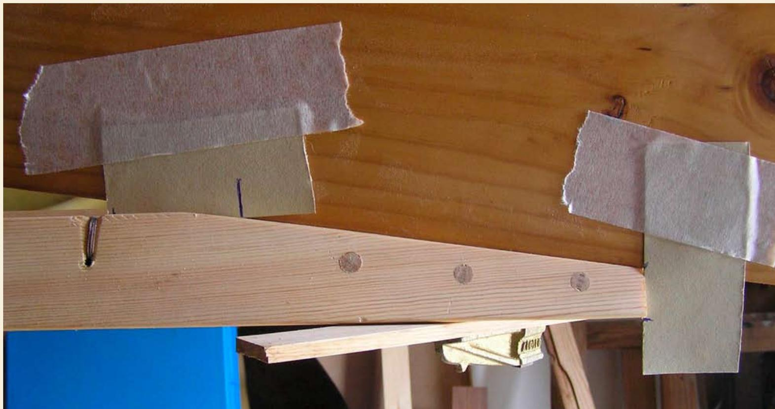
**P**ara realizar un encaje ajustado el método de las plantillas es ideal. Se parte de un tablón del mismo grosor que el definitivo, se coloca sobre la superficie previamente preparada de las bordas (se han planeado a 90° en toda la superficie que entrará en contacto con la pieza, rebajando hasta que el extremo es de la misma anchura que el grosor de la pieza a añadir)
