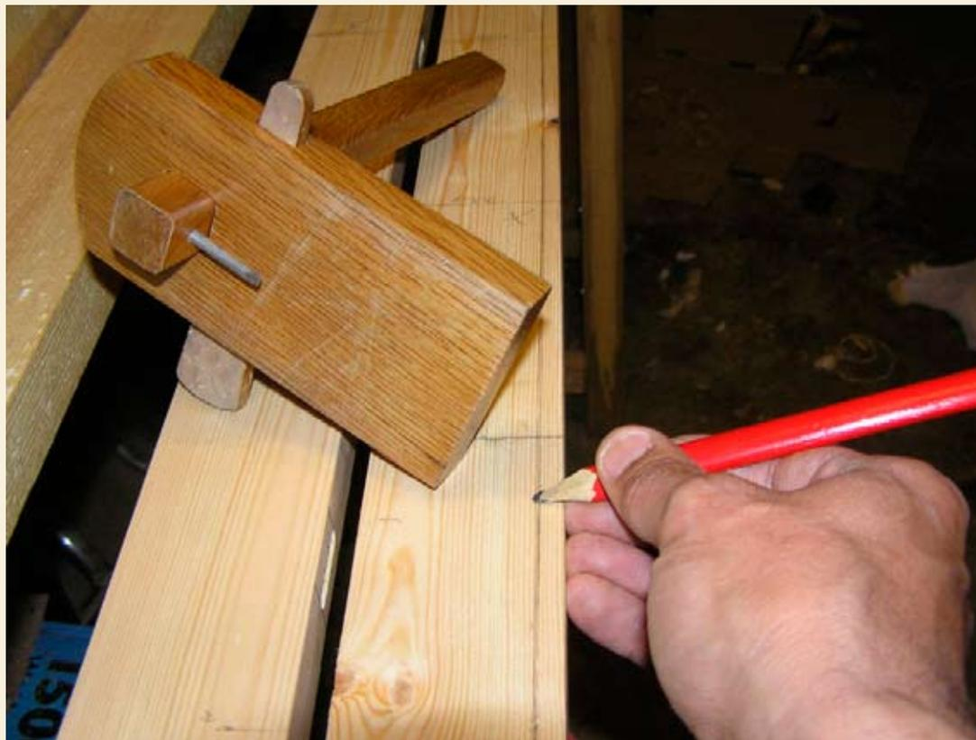
Me resulta lento de ajustar, con poca base, la rueda no llega a algunas partes.. De hecho, prefiero, con mucho, el que se observa a la derecha: un simple lápiz pinzado con tres dedos, tres más (de la misma mano!!) apoyados con firmeza en el borde y actuando de guía. Versátil, universal, preciso con un poco de práctica y siempre a mano!
